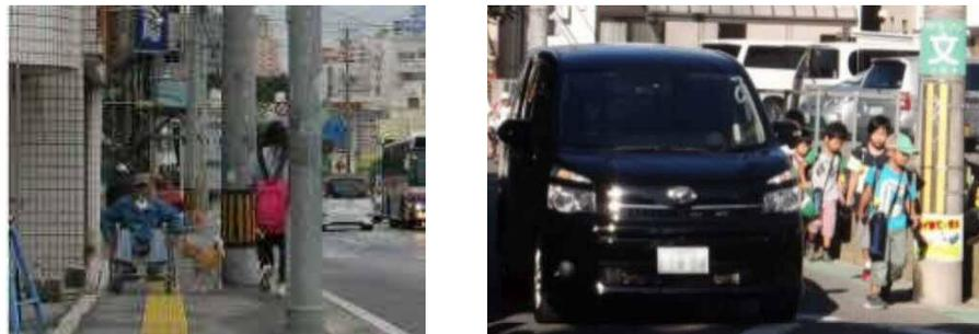
図8 歩行者の通行を妨げる電柱の例
