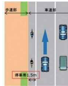
図 3-7 停車帯 (1.5m) の自転車通行空間イメージ
