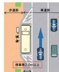
図 3-8 停車帯 (2.0m 以上) のイメージ
