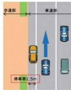
図 3-6 停車帯 (1.5m) のイメージ
