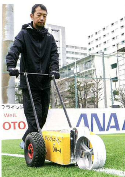
ディンプルマーカーという器具を使い、手押しで線を描いていく
