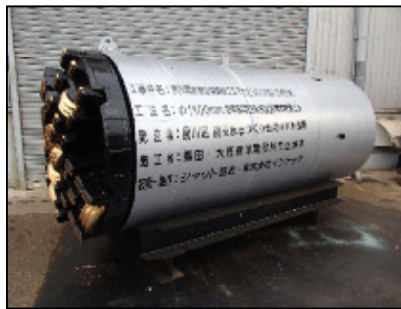
取水管の整備に使用した推進機 (直径１．１ｍの下水管を掘りました)
