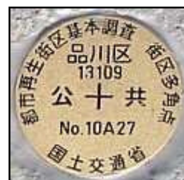
上の写真：街区多角点
