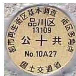
街区多角点標識
