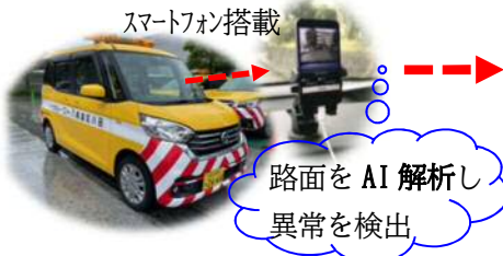
道路点検パトロールにAIを活用した道路損傷検出サービスを利用
