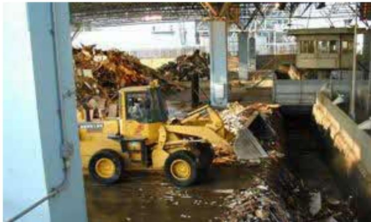
区が収集した「粗大ごみ」を処理する施設で、鉄、アルミニウムを機械選別で取り出し再資源化するほか、資源化物を回収した残りのごみを破碎するなど、不燃ごみの容積を減らしています。
