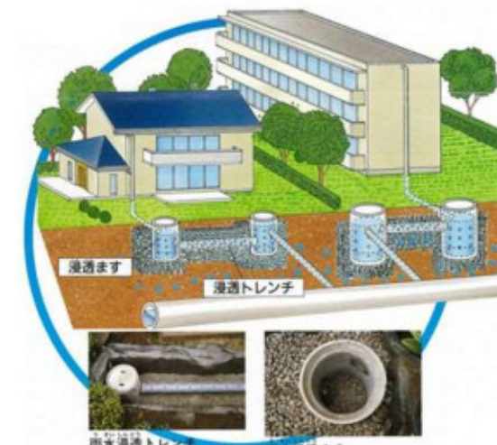
宅地内雨水浸透施設
