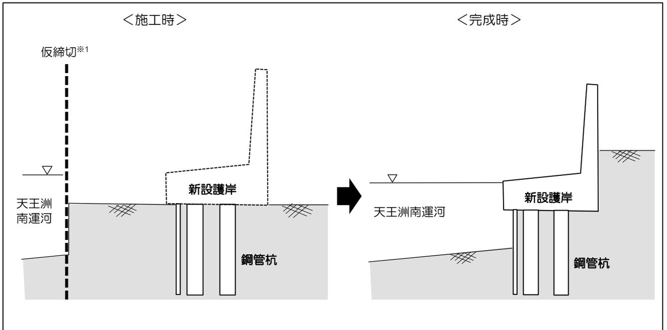
※1 仮締切とは、鋼管杭および新設護岸の施工時に、天王洲南運河の水が浸入しないよう締め切るための板
